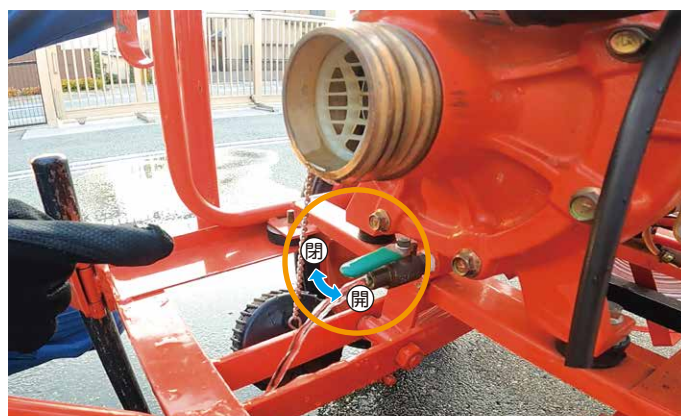
20 放水弁とドレンバルブを開いて排水し、再度放水弁を閉じる
